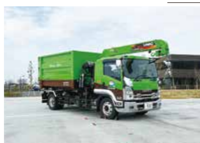
[7t クレーン付きコンテナ車 3台]
